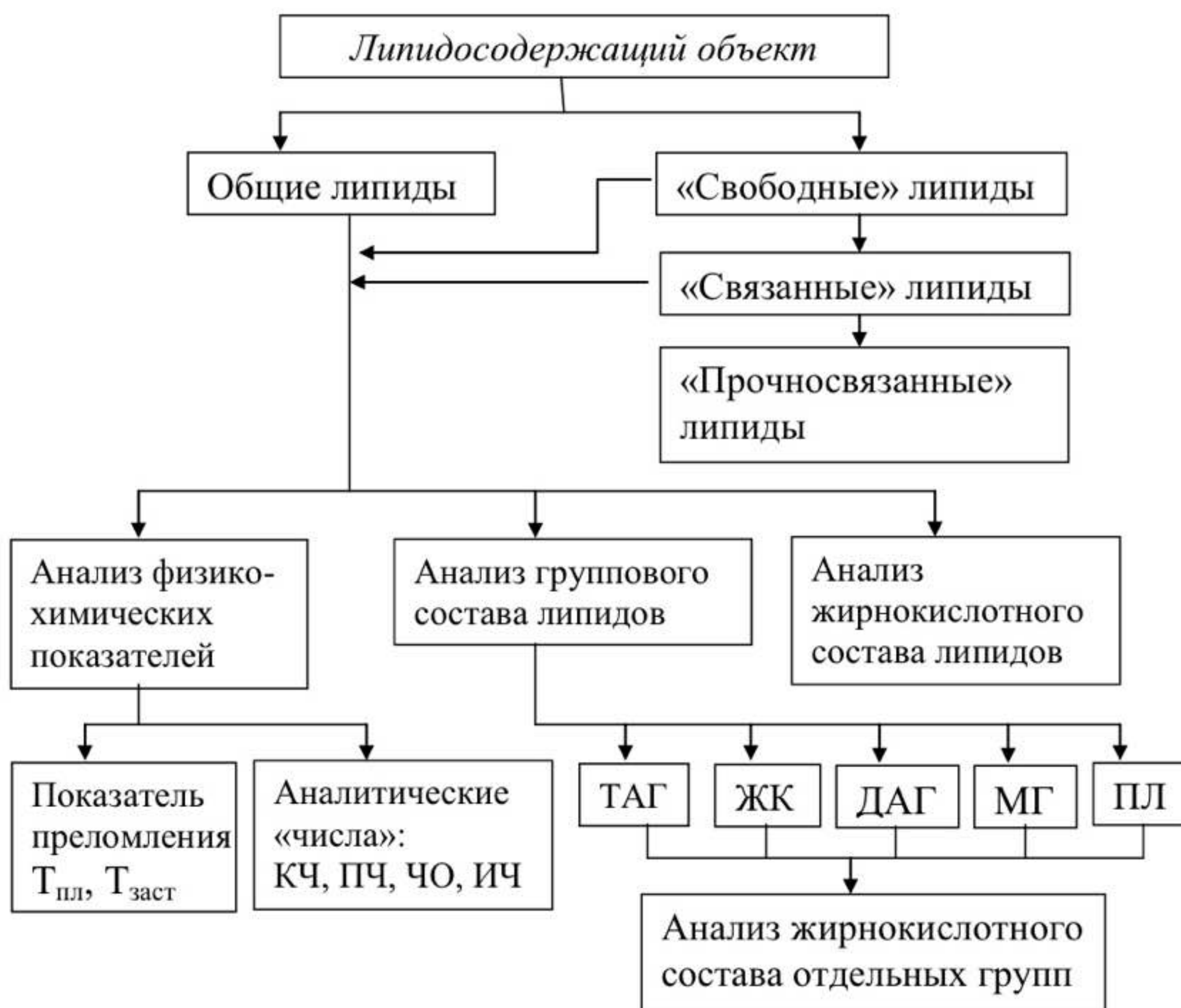
Рисунок 2.1 – Общая схема выделения и анализа липидов: КЧ – кислотное число; ПЧ – перекисное число; ЧО – число омыления; ИЧ – йодное число; ТАГ – триацилглицерины; ДАГ – диацилглицерины; МГ – моноацилглицерины; ЖК – жирные кислоты; ПЛ – полярные липиды
