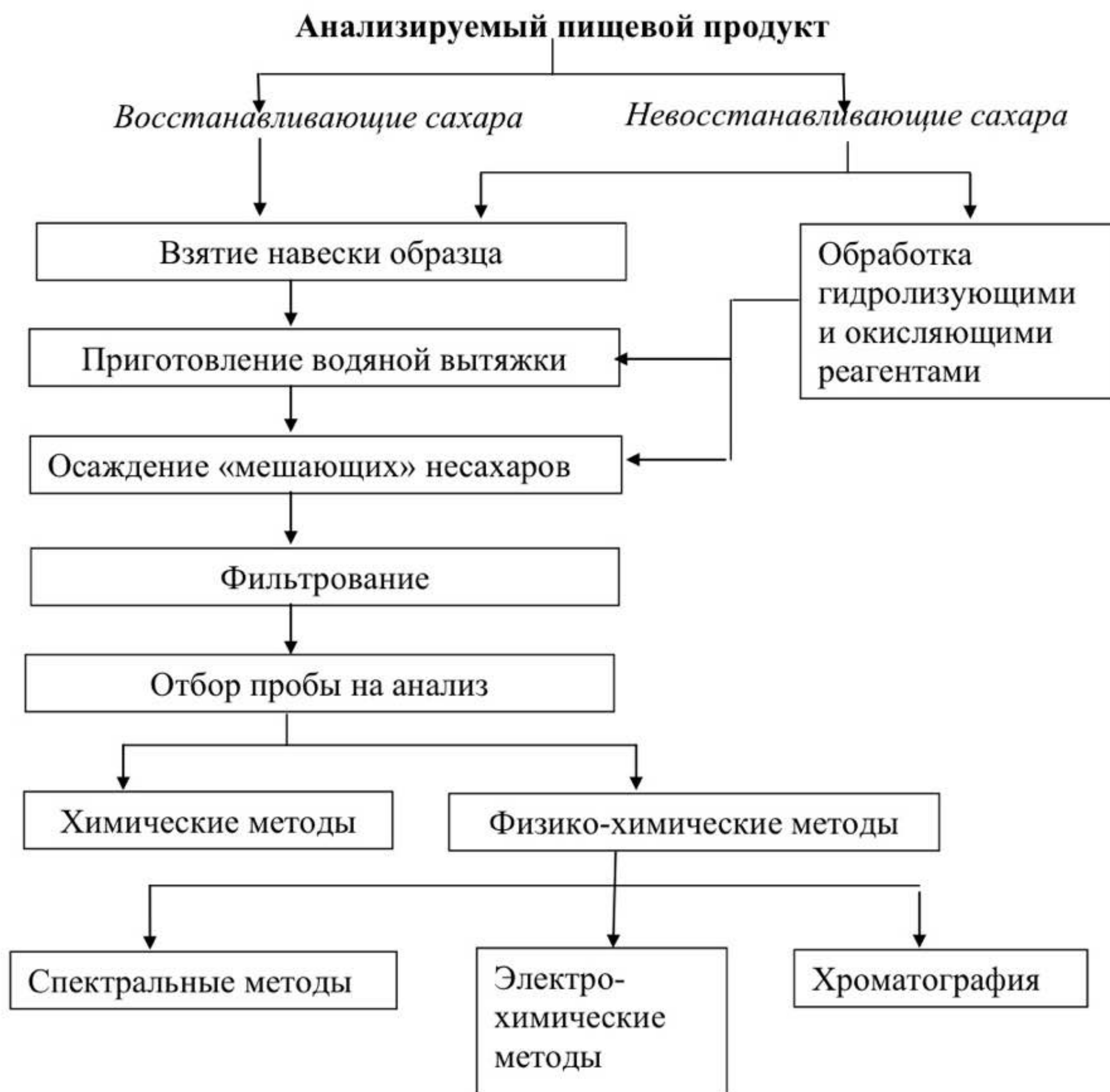
Рисунок 3.1 – Схема анализа углеводов пищевого сырья и продуктов питания
